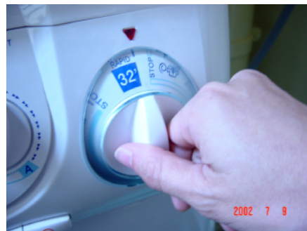
6. 左邊旋轉掣可調校溫度，零度為冷水，右邊旋轉掣請維持於此狀態
